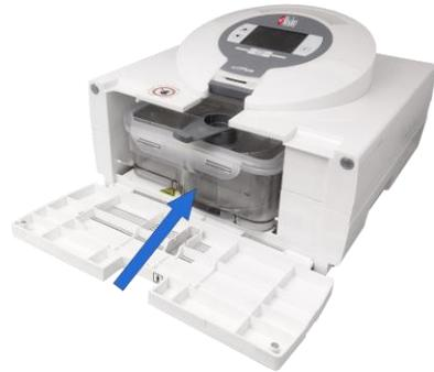
**WARNUNG:** Entleeren Sie die Luftbefeuchterkammer vollständig, bevor Sie das Gerät versenden!
