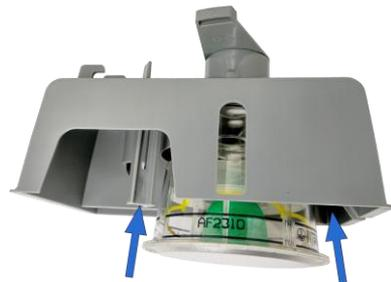
**2** Führen Sie die Zuleitung der *Befeuchtungskammer* wie abgebildet durch die Öffnung im *Luftbefeuchter-Rack* und durch die Halterungen.
