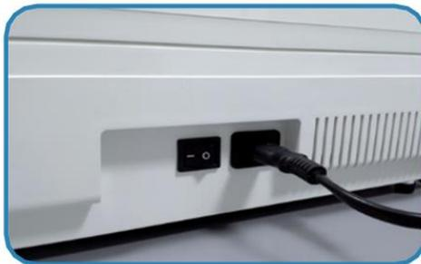
**Hinweis:** Das Gerät führt beim Hochfahren einen Selbsttest durch: Es muss ein Alarmton zu hören sein.
