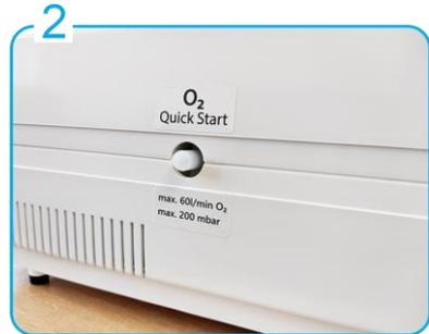
Schließen Sie eine externe Sauerstoffquelle mit einem speziellen Sauerstoffschlauch an den Sauerstoffeinlassanschluss des Geräts an.
