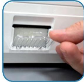
Ersetzen Sie den Staubfilter durch einen neuen, bzw. setzen Sie den gereinigten Staubfilter wieder ein. Setzen Sie die Staubfilterabdeckung ein, indem Sie zuerst die untere Kante einhaken. Verriegeln Sie den Staubfilterdeckel durch leichten Druck auf die obere Kante.
